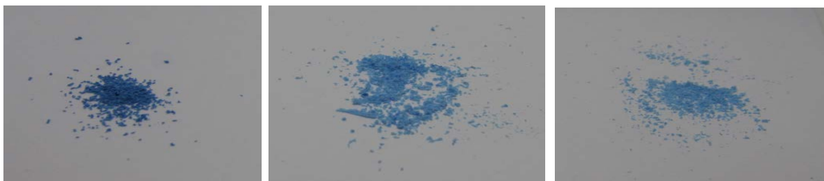
Abbildung 18: Pulver aus Gehäusematerial, v.l.n.r.: Original, Fälschung 1, Fälschung 2.
