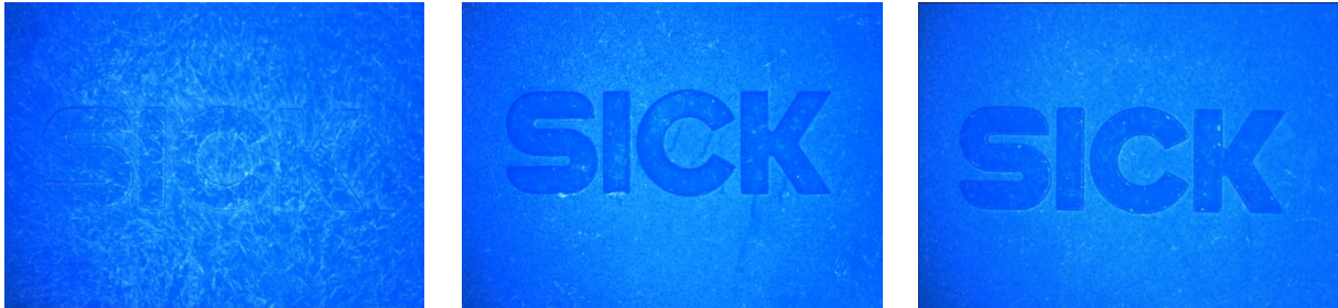
Abbildung 17: Oberflächen von Sick GL6 Sensorgehäuse; v.l.n.r.: Original, Fälschung 1, Fälschung 2.
