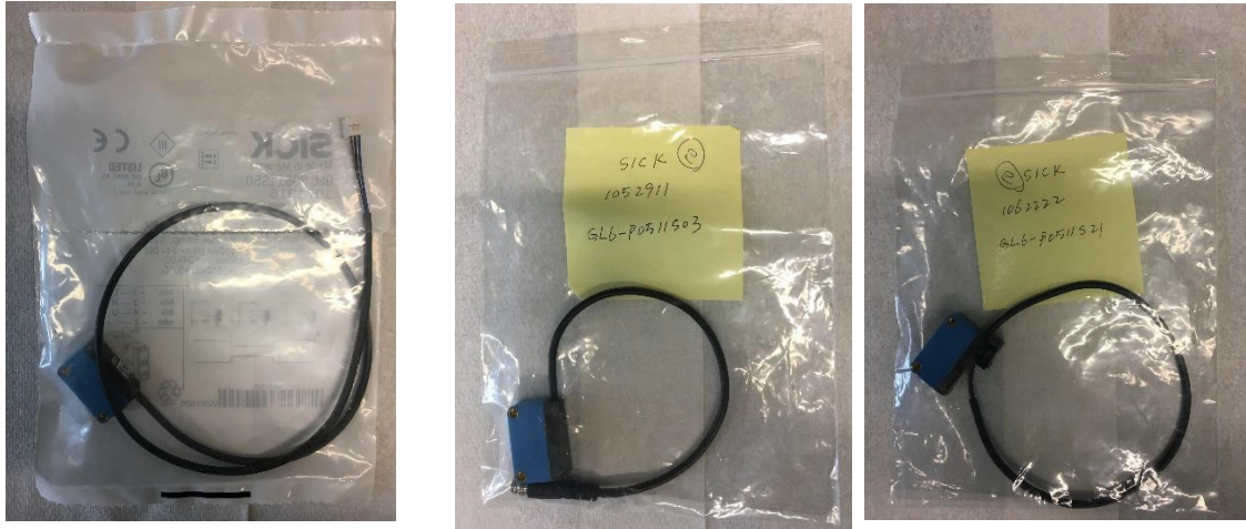
Abbildung 15: Sensoren mit Packung. Von links nach rechts: Sick GL6 P0511S50, GL6 P0511S03, GL6 P0511S21.
